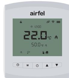
При деактивации блокировки, символ “” исчезает и кнопки терmostата приводятся в активное состояние. Блокировка против детей, активируется / деактивируется через меню Параметров.
